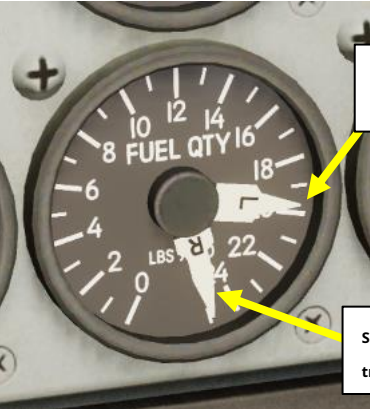
Indicador de cantidad del sistema de combustible izquierdo (celda de combustible delantera) (x100 lbs)
